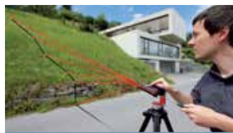
斷面測量功能 進行坡度斷面資訊測量
