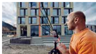
高度跟蹤功能 直接遠程測量房屋的高度
